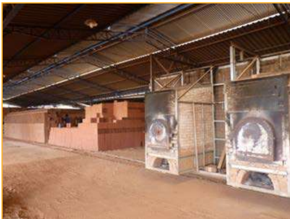
Figura 18 – Forno metálico móvel: lote pronto (esq.) e portas metálicas do forno móvel (dir.)
