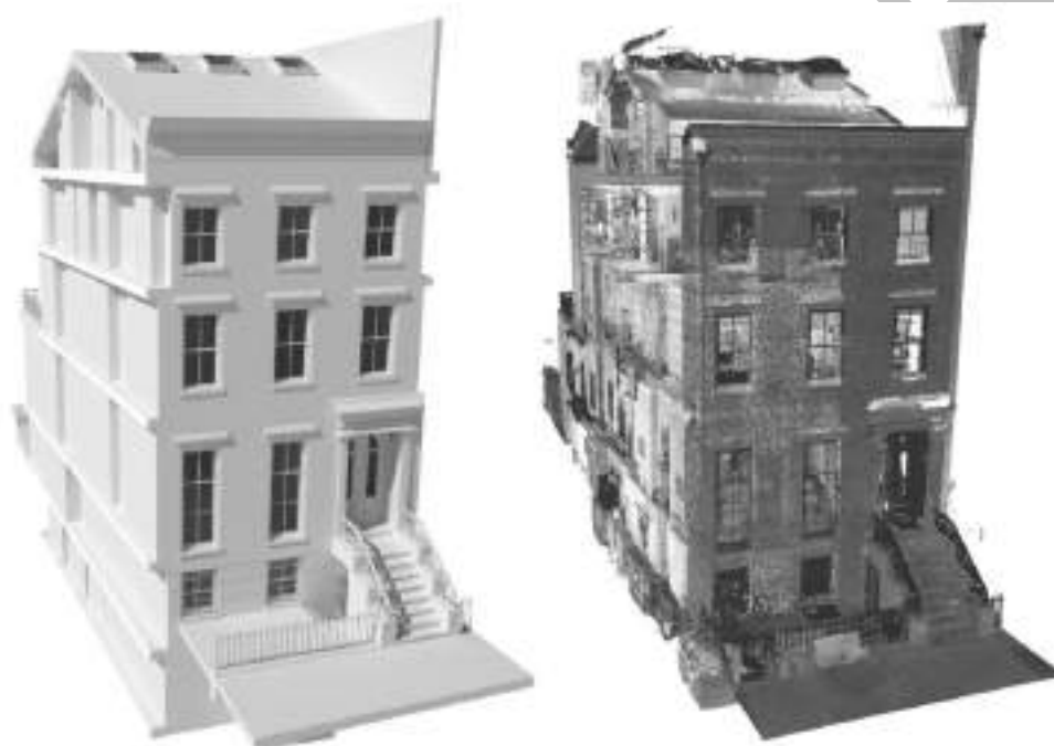
Figura 1 - Modelo de malha geométrica (esq.) e modelo de nuvem de pontos (dir.). Fonte: (Pavlo H, [s. d.]
