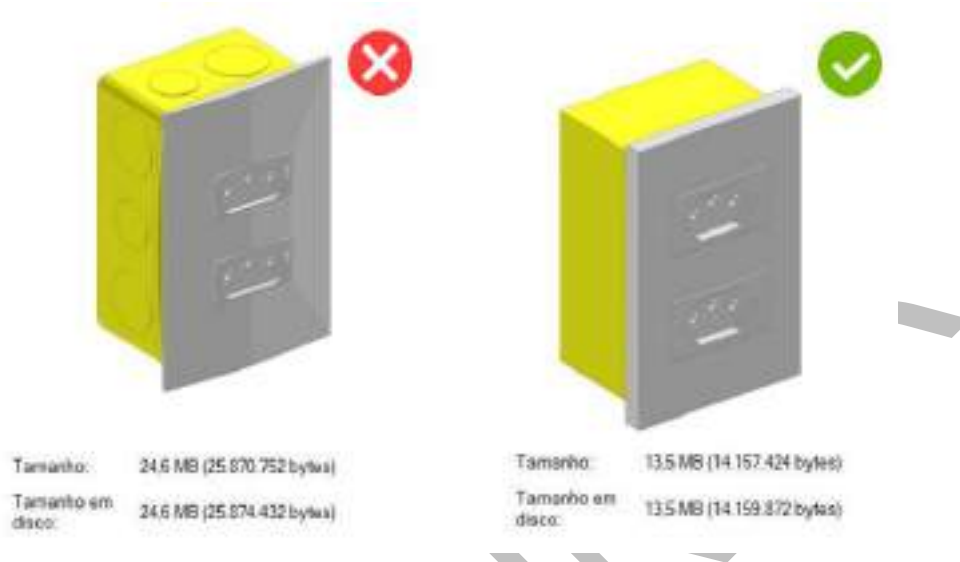
Figura 17 - Comparativo entre elementos sem (esq.) e com (dir.) simplificação de geometria
